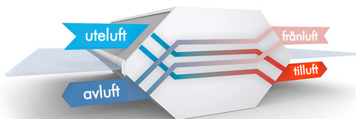
Motströmsvärmeväxlare i aluminium med mer än 80% temperaturverkningsgrad.
